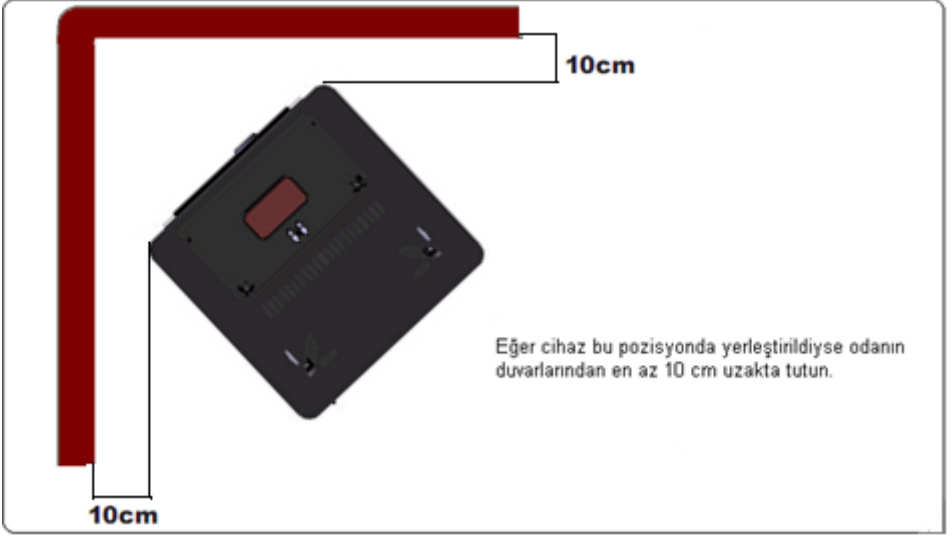
Şekil 7: Cihazın duvar önünde kurulumu
