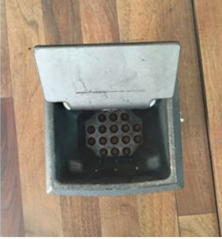
Şekil 15 A: Temiz yanma hücresi
