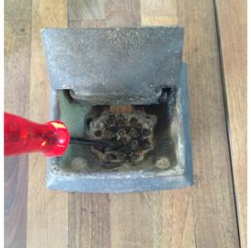
Şekil 15 B: Kirli yanma hücresi
