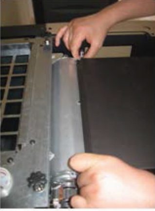
Őekil 19: Duman geiŐ boruları temizliđi
