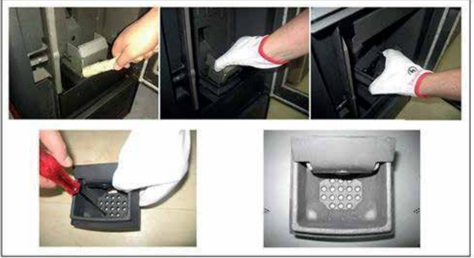
Şekil 17: Yanma hücresi ve yanma haznesi temizliği
