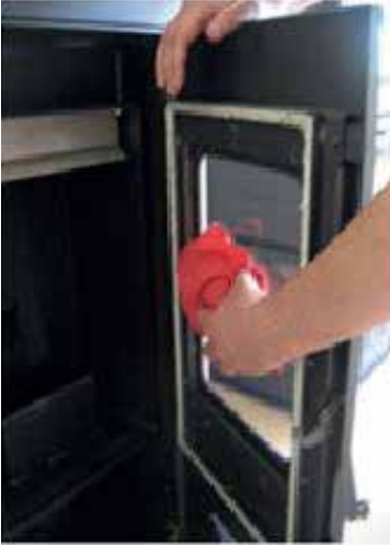
Şekil 16: Cihazın cam temizliği
