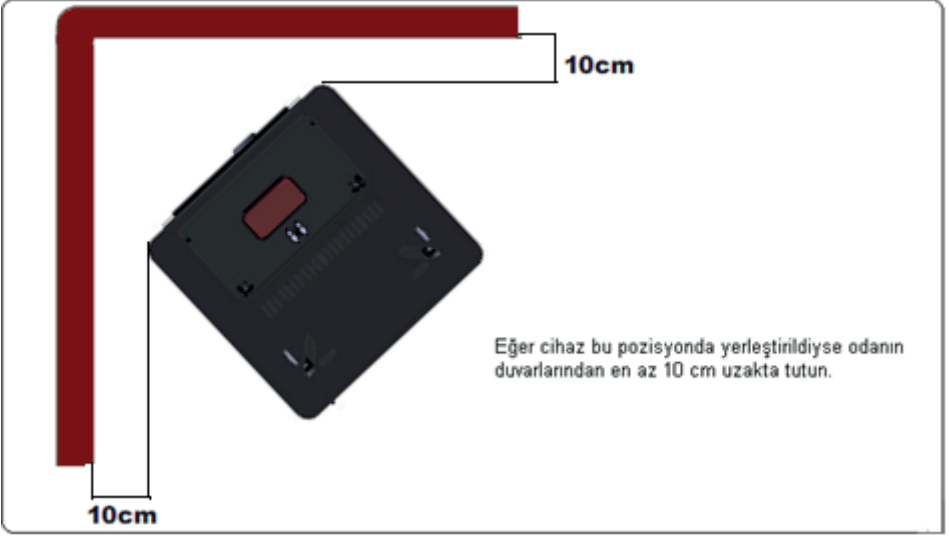
Şekil 7: Cihazın duvar önünde kurulumu
